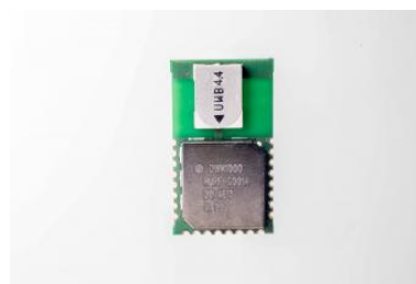
(b) Module DWM1000 [27] (transceiver et son antenne planaire céramique).
