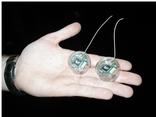
FIGURE 1.1.2 – Deux nœuds «dots» d'un réseau de capteurs expérimental [9].
